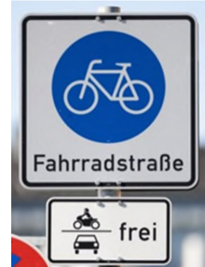
VZ 244.1 – Beginn einer Fahrradstraße
